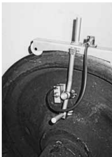
Устройство типа УСК для контроля одной зоны колеса
