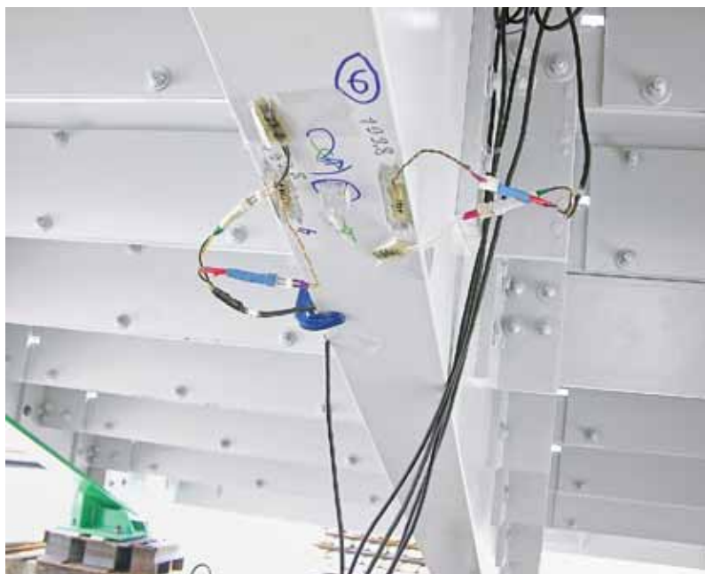
Расположение тензорезисторов на косоурах лестничного марша
