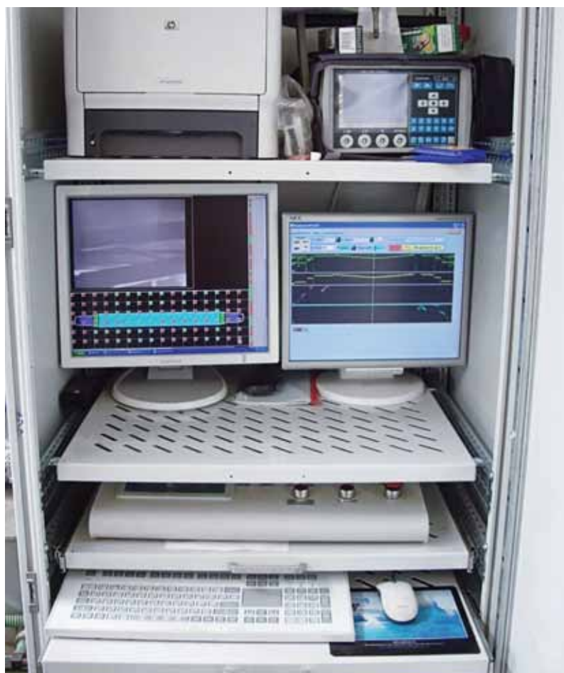
Дефектоскоп УДС2-52 «ЗОНД-2» в составе аппаратуры автоматизированного комплекса «Ультра-Маг-01»
