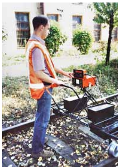
Испытания регистратора УР-3Р с дефектоскопом РДМ-2 (И.З.Этинген)
