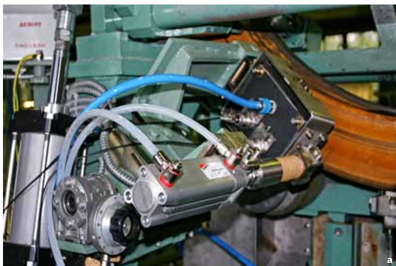
Акустические блоки для прозвучивания бандажей в установке УКБ-1Д
