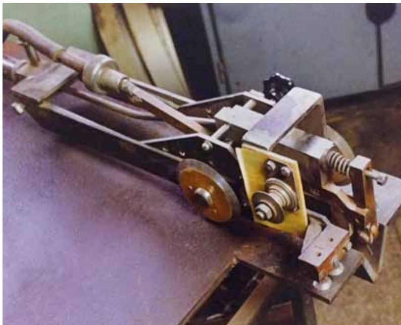
Удлинительная приставка для сварки нижних поясов комбинированных стыков балок двутаврового и коробчатого сечений
