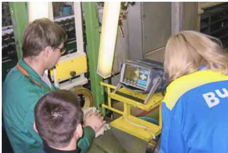
Испытания дефектоскопа УДС2-52 «ЗОНД-2» в вагонном депо Горький-Сортировочный
