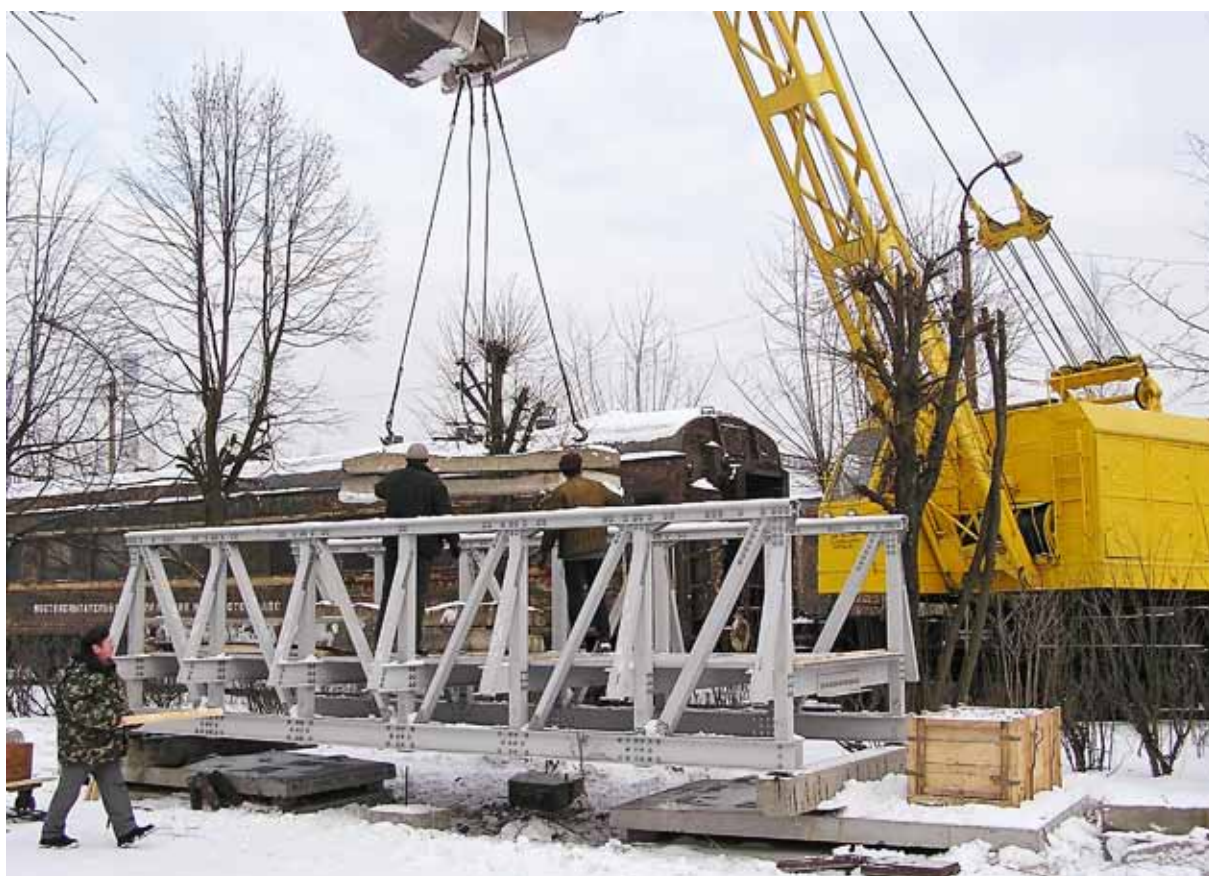
Загрузка фрагмента пешеходного пролетного строения статической нагрузкой
