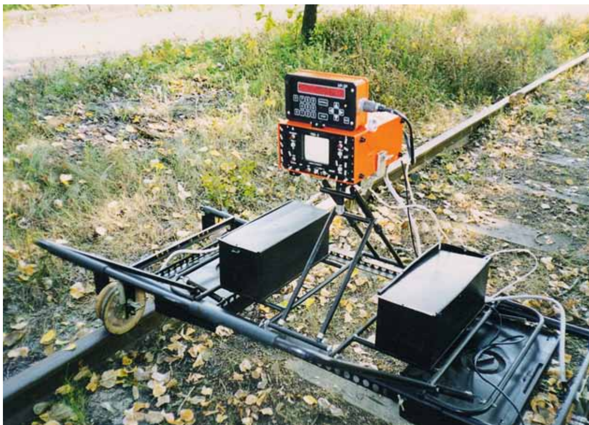
Дефектоскоп УДС2-РДМ-2 с регистратором «УР-ЗР»
