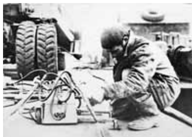
Двухдуговой автомат для сварки наружных стыковых швов коробчатых элементов модели АС2-«С»
