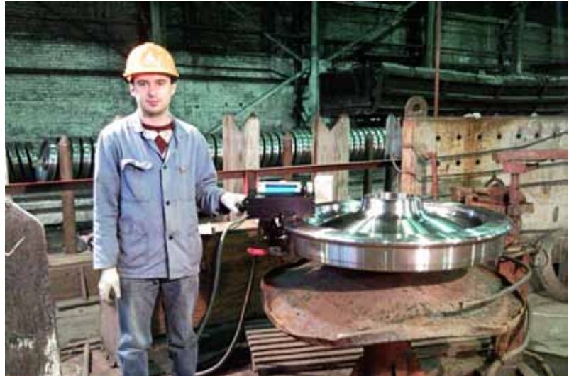
Измерения напряжений в ободьях колес (С. А. Краснобрыжий)
