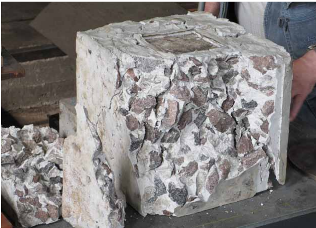
Образец, изготовленный из щебня и полимерного двухкомпонентного композиционного материала на неорганической основе, для укрепления балластной призмы эксплуатируемых железнодорожных мостов после испытаний на прессульсаторе ГРМ-1
