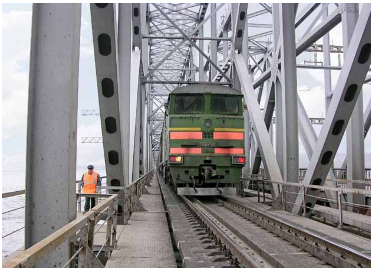
Динамические испытания пролетного строения испытательной нагрузкой на мосту через Волгу около Ульяновска
