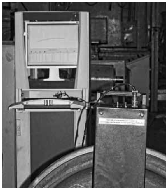
Оборудование УКОН-01 для измерения остаточных напряжений в ободьях колес
