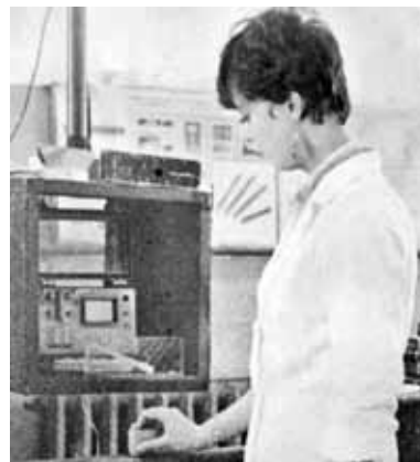
Исследование выявляемости дефектов рельсов на РСП-1, ст. Предпортовая (М. С. Мельникова)
