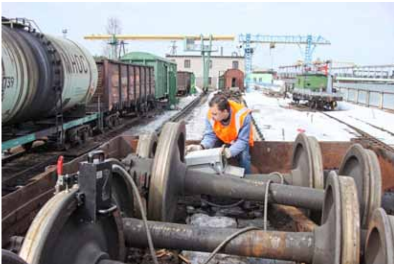
Измерения напряжений в ободьях колес (С. А. Краснобрыжий)
